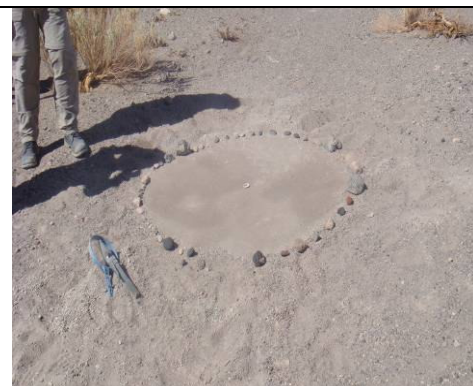
Fotografía 14. Trampa terminada, tierra harneada, demarcada y con pastilla cargada.
