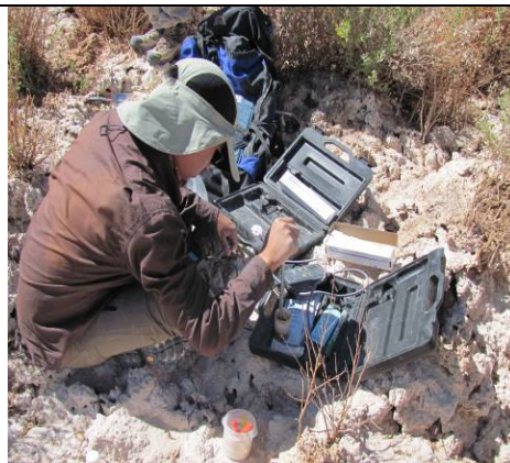
Fotografía 6. Análisis pH y conductividad eléctrica en muestra de suelo.
