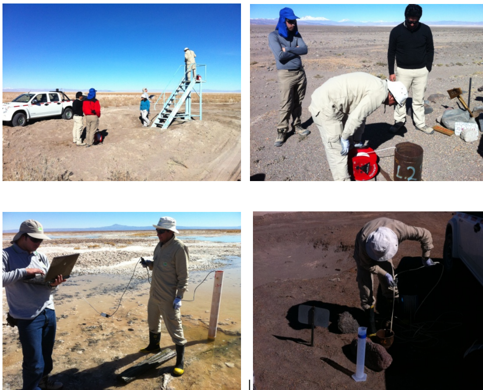
Figura 1: Equipo de SQM realizando mediciones de niveles piezométricos y de parámetros físico químicos in situ, como parte del Plan de Contingencia de SQM.
