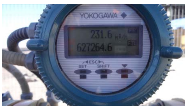
Figura 13: Pozo Socaire para extracción de agua fresca para uso industrial y flujómetro certificado.
